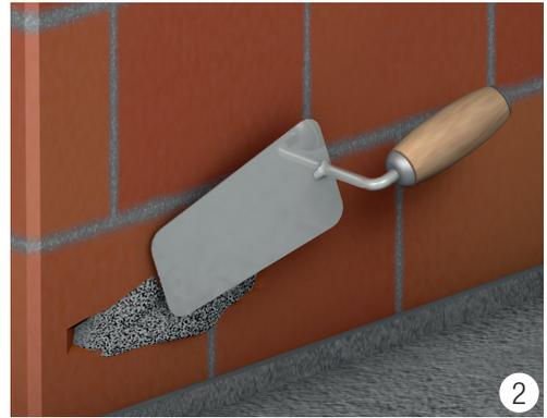
Den Untergrund gemäß der Tabelle auf S. 11-12 vorbereiten. Falls erforderlich, mit PRIMAPOX M abdecken. Eine dünne Schicht SEALPUR SILAN TX auftragen und die Spachtelmasse auftragen. Alternative: SEALPUR SILAN TX und TX Powder CX 40 (Verdickungspulver).
